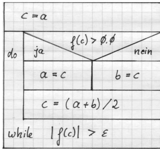
Obige Bisektion kann auch mittels eines abweisenden Zyklus realisiert werden.
