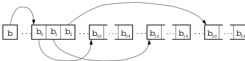
**Achtung:** Es gibt keine Garantie, daß die einzelnen Zeilen der Matrix hintereinander im Speicher angeordnet sind. Somit unterscheidet sich die Speicherung des dynamischen 2D-Feldes von der Speicherung des statischen 2D-Feldes obwohl die Syntax des Elementzugriffes `b[i][j]` identisch ist. Dafür ist diese Matrixspeicherung flexibler, da die Zeilen auch unterschiedliche Längen haben dürfen (dünnbesetzte Matrizen oder Matrizen mit Profil).
