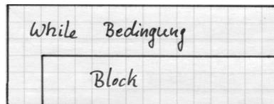
Bemerkung: Falls der allererste Test im abweisenden Zyklus FALSE ergibt, dann wird der Anweisungsblock im Zyklusinneren nie ausgeführt (der Zyklus wird abgewiesen).
