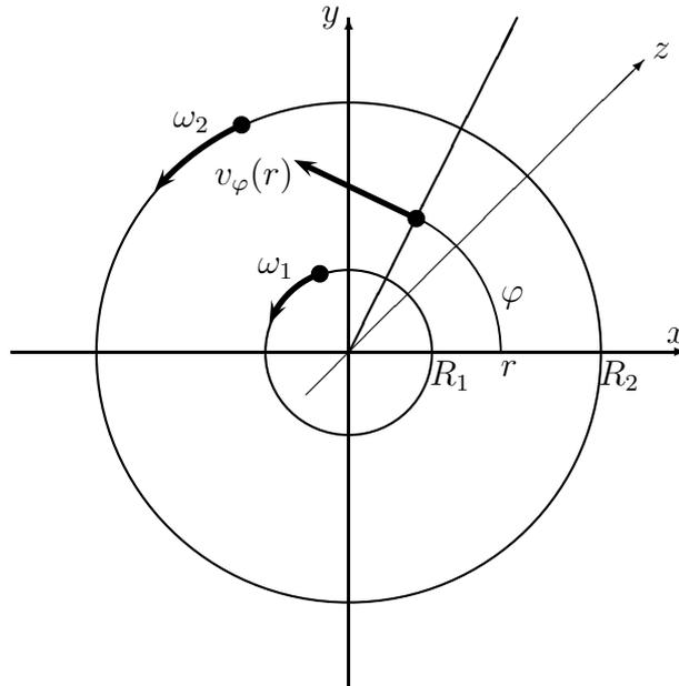
Abbildung 2: Querschnitt durch einen (endlosen) Doppelzylinder mit zwei sich verschieden schnell drehenden Mänteln.
