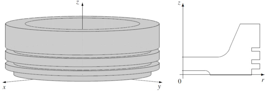
Abbildung 1: Oberer Teil des Kolbens eines Verbrennungsmotors und Meridianebene
