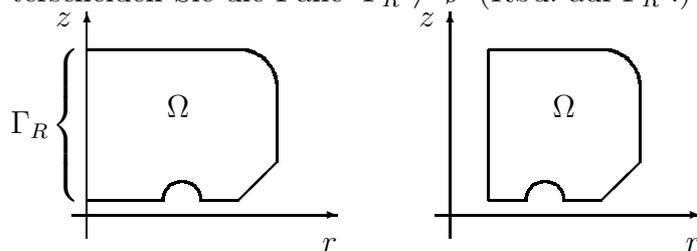
**TP Ib** Man schreibe die differentielle Form der Wärmeleitgleichung für das Modellproblem “*Kolben*“ Querschnittsgebiet (2D) auf. Beachten Sie das Vorhandensein eines Interfaces zwischen Stahl und Keramikeinlage (Interface-Bedingung).
