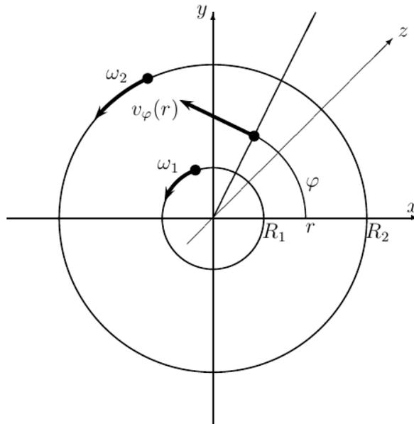
Abbildung 3: Querschnitt durch einen (endlosen) Doppelzylinder mit zwei sich verschieden schnell drehenden Mänteln.
