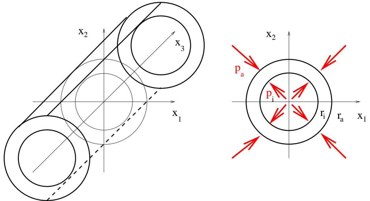
Man leite aus den Beziehungen der 3D Elastizitätstheorie (Kinetik, Kinematik, Hooksches Stoffgesetz, Randbedingungen) ein möglichst einfaches Modell zur Festigkeitsberechnung des Rohres her ! Bestimmen Sie die Lösung ( $u_r(r) = ?$ ,  $\sigma_{rr} = ?$ ,  $\sigma_{\phi\phi} = ?$ ,  $\sigma_{r\phi} = ?$ ) analytisch, falls das möglich ist !
